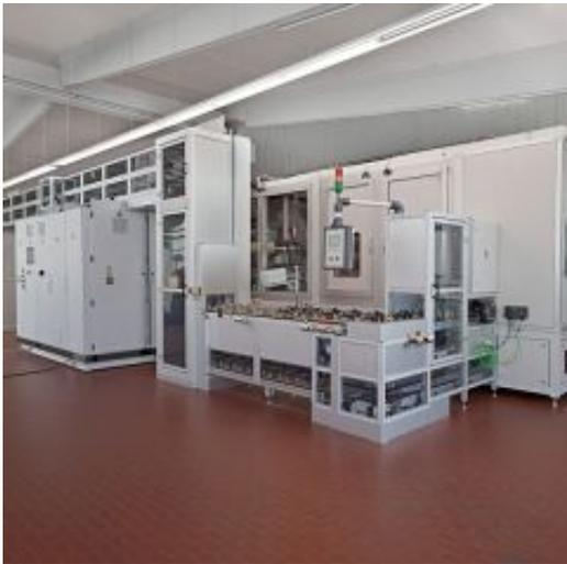
DTA für Getriebe-Steuerungen im Bereich von  $-40^{\circ}\text{C}$  bis  $+160^{\circ}\text{C}$  mit Prüf-Adaptern
