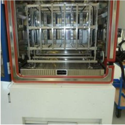
Airbag-Sensoren auf Run-In-Boards bestückt
